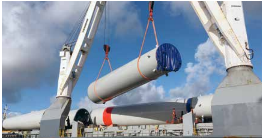
Auf der „HR Constitution“ wurden Turmsegmente und Rotorblätter zusammen geladen
